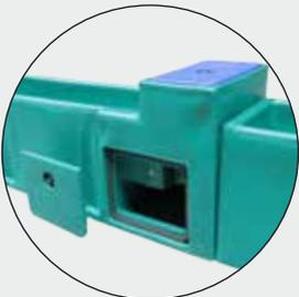
Сервисное отверстие для подключения воды и электроэнергии
